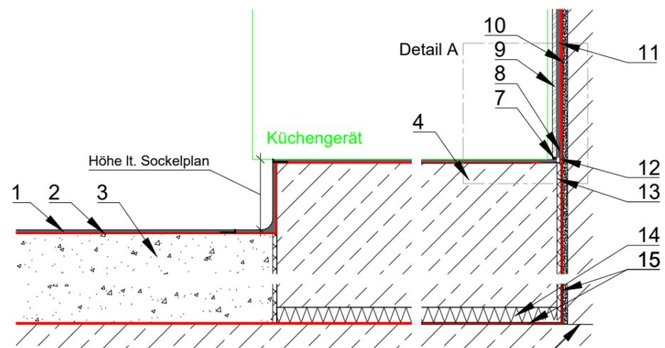
Bei erdberührenden Bauteilen muss eine zusätzliche bituminöse Bauwerksabdichtung vorgesehen werden!
