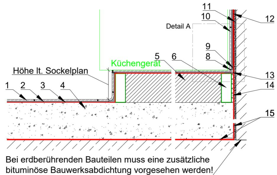
Bei erdberührenden Bauteilen muss eine zusätzliche bituminöse Bauwerksabdichtung vorgesehen werden!
