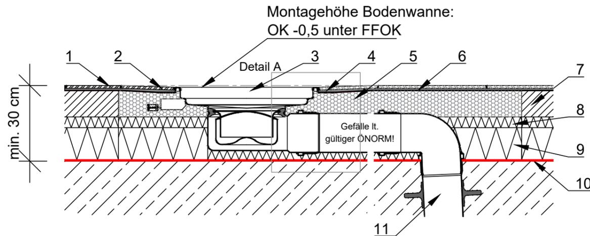
\* Wärme- und Trittschalldämmung innerhalb der Estrichabsenkung wird nach dem Einrichten der Bodenwanne wieder hinzugefügt (siehe Montageausführung)!
